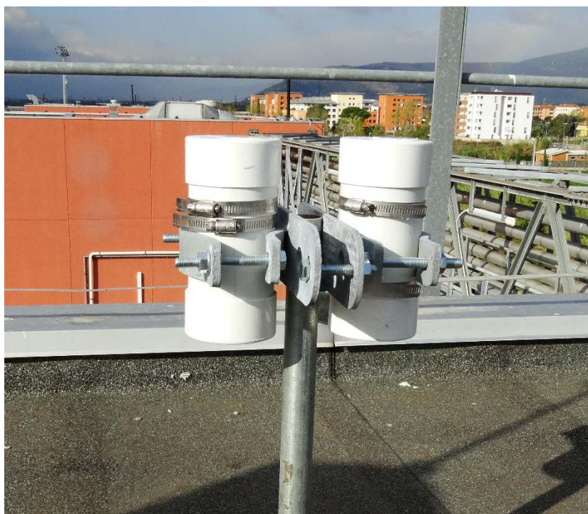
Figura 5 - Sensori SQM installati sul tetto dell'area di ricerca del CNR di Firenze
