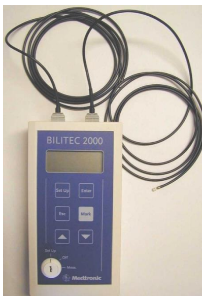
Figura 2 - Il sensore Bilitec 2000 per la misura del reflusso contenente bile
