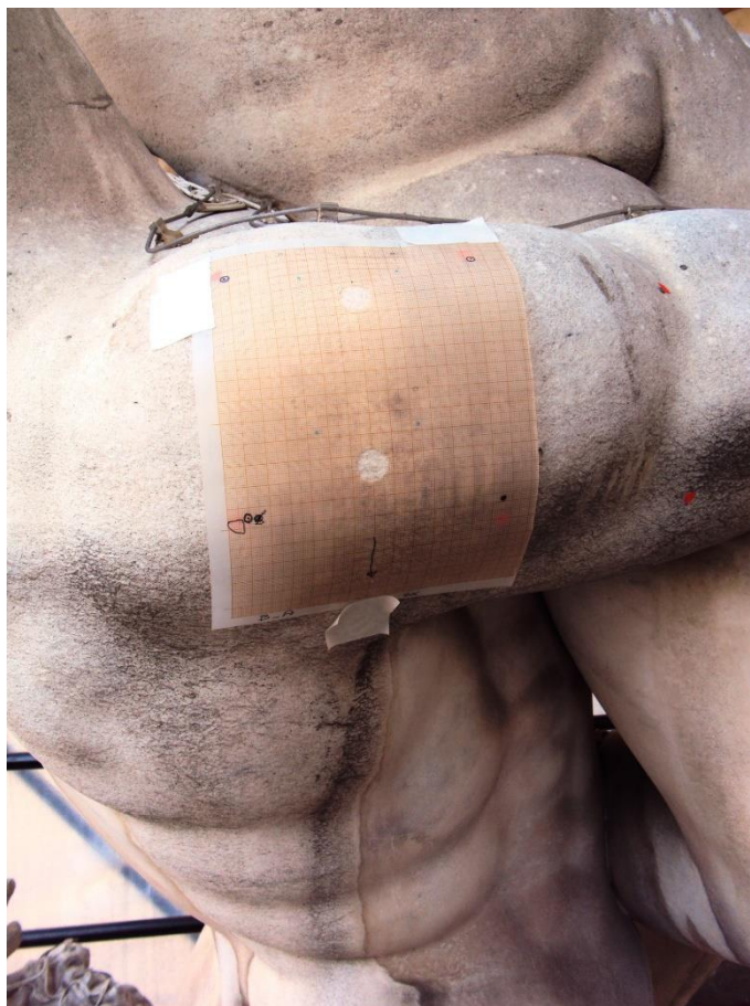
Figura 7 – Particolare del Ratto della Sabina . Maschera di riposizionamento impiegata per garantire la ripetibilità delle misure su una delle aree oggetto d'indagine
