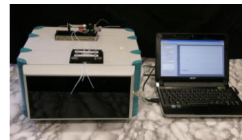
Fig. 1 – Sinistra: chip a tredici canali per la rivelazione simultanea di più analiti per la diagnosi della sepsi. Destra: dispositivo portatile realizzato presso IFAC-CNR.
