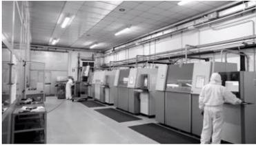
CRP Technology S.r.l. (Modena), è specializzata nel servizio di Additive Manufacturing e stampa 3D professionale, mediante impiego della tecnologia SLS (Sinterizzazione Selettiva a mezzo Laser) e l'uso dei materiali compositi ad alte prestazioni Windform. L'azienda dispone di 10 macchinari professionali SLS (con capacità di stampare pezzi monolitici fino a 550X550X500mm) e di operatori professionali formati per soddisfare le necessità dei settori industriali più esigenti.
